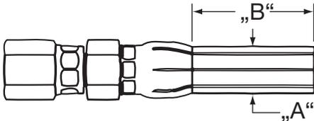
Aspetto delle serie di raccordi 56 e 93N dopo la pressatura
