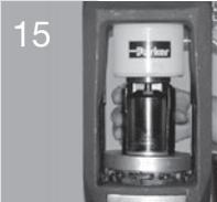
Far scivolare il dispositivo di spinta in posizione verso il bullone a perno.
