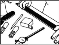
Posizionare il tubo assemblato a doppia linea o multilinea in modo che resti in posizione piatta sulla superficie di lavoro senza tendenza a torcersi o girarsi.
