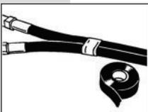
A seconda dei requisiti di installazione si consiglia l'applicazione di una striscia o di un nastro di nylon legante alla fine della parte separata per evitare che i rivestimenti esterni dei tubi si strappino.
