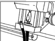
La distanza di separazione deve essere sufficiente a evitare il rischio di attorcigliare i tubi durante l'operazione di pressatura.
