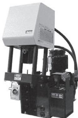
Per tubo Parker con trecce tessili e in filo di acciaio, nonché strati in filo di acciaio a spirale fino a DN 32. Con dispositivo idraulico e telaio di base, ma senza matrici.
