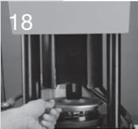
Inserire la metà frontale del distanziale diviso allineando il perno della metà posteriore con il foro della metà anteriore.
