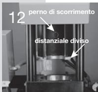
Con il dispositivo di spinta in posizione completamente sollevata, posizionare la metà posteriore del distanziale diviso nella parte posteriore del dispositivo di spinta. Bloccare l'anello in posizione inserendo il perno di scorrimento.
