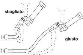
Quando il tubo assemblato è installato in un'applicazione flessibile, tenere presente che i raccordi per tubi in metallo non fanno parte della porzione flessibile.
