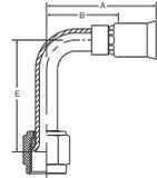
**MATERIALE** Acciaio galvanizzato con placcatura trasparente senza Cr(VI).
