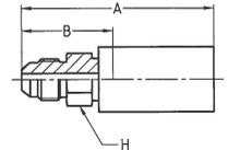
**MATERIALE** Acciaio galvanizzato con placcatura trasparente senza Cr(VI).
