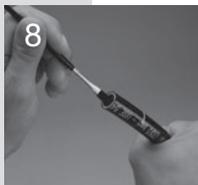
Utilizzando un olio lubrificante SAE 20 lubrificare leggermente l'estremità interna del tubo (Utilizzare una soluzione a base di sapone per manutenzione a ossigeno.)
