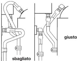
Utilizzare i gomiti o gli adattatori a seconda delle necessità, per eliminare la lunghezza del tubo in eccesso e per assicurare un'installazione più precisa e una manutenzione più semplice.
