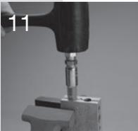
Utilizzando un mazzuolo in gomma, inserire il raccordo sul tubo fino a che il fondo del guscio del raccordo non sia allineato con la tacca di inserimento in profondità. Ripetere i passaggi da 7 a 10 per l'altra estremità del tubo, se necessario.
