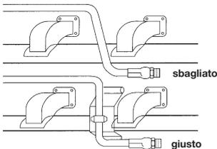
Evitare di installare i tubi assemblati vicino a fonti di calore. Tuttavia, se si rende necessario, isolare il tubo.
