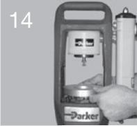
Posizionare l'anello della matrice adeguato sulla parte superiore della matrice selezionata. Si veda la Tabella Selezioni Utensili Assemblaggio Aggraffatubi del presente manuale ai fini di un'adeguata selezione dell'anello della matrice.
