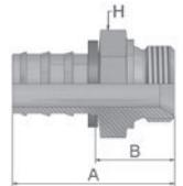
**MATERIALE** Acciaio galvanizzato con placcatura trasparente senza Cr(VI).
