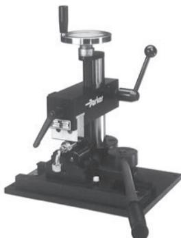
**polyflex** TH4-4 è utilizzata per la marcatura permanente dei tubi assemblati o per la ghiera di pressatura del raccordo del tubo. Il modello standard include il dispositivo da tavolo con piastra di base, volantino regolabile in altezza, supporto di tipo fisso, e contenitore delle lettere con caratteri in acciaio temprato.
