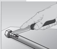
Tagliare il tubo in senso longitudinale lungo una linea a circa un angolo di 20° dalla linea centrale del tubo. Assicurarsi di non scheggiare le alette del raccordo.
