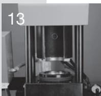
Installare la vaschetta dell'adattatore nella piastra di base dell'aggraffatrice per misure di tubi da 4 a 20.
