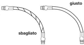
Il tubo si indebolisce quando è installato in posizione ritorta. Inoltre gli impulsi di pressione nel tubo ritorto tendono a sforzare il filo e ad allentare le connessioni del raccordo. Progettare i tubi in modo che il movimento della macchina provochi una piegatura anziché una torsione.
