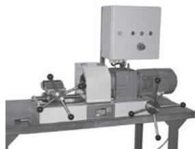
La macchina per pre-assemblaggio dei tubi **polyflex** SMM 100 facilita il collegamento dei raccordi. Il modello standard include armadio elettrico, interruttore a pedale e mandrino di sicurezza a tre morsetti. Il modello SMM 100 è adatto per raccordi fino alla misura DN 32.
