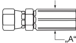
Aspetto delle serie di raccordi 91N dopo la pressatura
