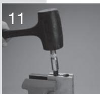
Utilizzando un mazzuolo in gomma, inserire il raccordo sul tubo fino a che il fondo del guscio del raccordo non sia allineato con la tacca di inserimento in profondità.
