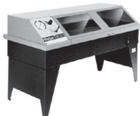
Questo banco di prova da laboratorio è utilizzato per il collaudo della pressione statica dei gruppi di tubi pronti per l'installazione. La pressione di prova varia da 12 a 145 MPa. Quasi tutti i raccordi standard possono essere testati.
