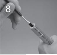
Utilizzando un olio lubrificante SAE 20 lubrificare leggermente le estremità interna del tubo (Utilizzare una soluzione a base di sapone per manutenzione a ossigeno.)
