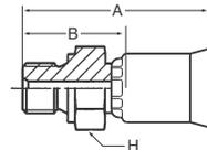
**MATERIALE** Acciaio galvanizzato con placcatura trasparente senza Cr(VI).
