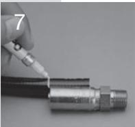
Segnare l'estremità del tubo con la linea di profondità di inserimento adeguata. (Profondità di inserimento = dimensione "A" meno "B" in base alle tabelle dei raccordi per tubi nei capitoli da B a E)
