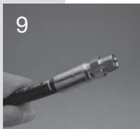
Inserire il tubo nel raccordo in profondità fino alla tacca di inserimento. (Se il raccordo non scorre prontamente sul tubo, passare alla fase successiva.)
