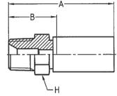
**MATERIALE** Acciaio galvanizzato con placcatura trasparente senza Cr(VI).
