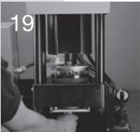
Inserire il tubo e il raccordo dal fondo dell'aggraffatrice e attraverso l'intero stampo. Posizionare il raccordo in modo che il fondo del guscio del raccordo si posizioni sul gradino dello stampo.
