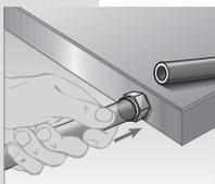
Inserire il raccordo nel tubo e spingere con forza fino a che il raccordo non è completamente inserito nel tubo. Serrare il tubo a circa 2,5 cm dall'estremità. In alternativa, utilizzare l'utensile di assemblaggio Parker 611050G.
