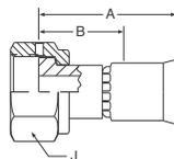
**MATERIALE** Nipplo, dado girevole e anello di pressatura in acciaio inossidabile (AISI 316); ghiera in acciaio inossidabile (AISI 303)
