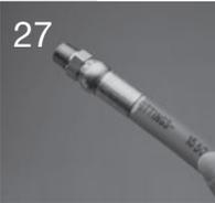
Esaminare la tacca di profondità di inserimento alle estremità del raccordo. La tacca di inserimento deve essere visibile ed essere a distanza di 3 mm dal fondo del guscio del raccordo.
