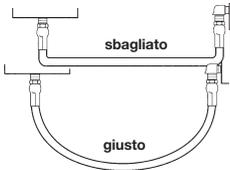
Il tubo deve uscire dall'accoppiamento in posizione diritta anziché laterale. Il raggio di piegatura minimo non deve essere superato, per evitare l'attorcigliamento del tubo e la restrizione del flusso.
